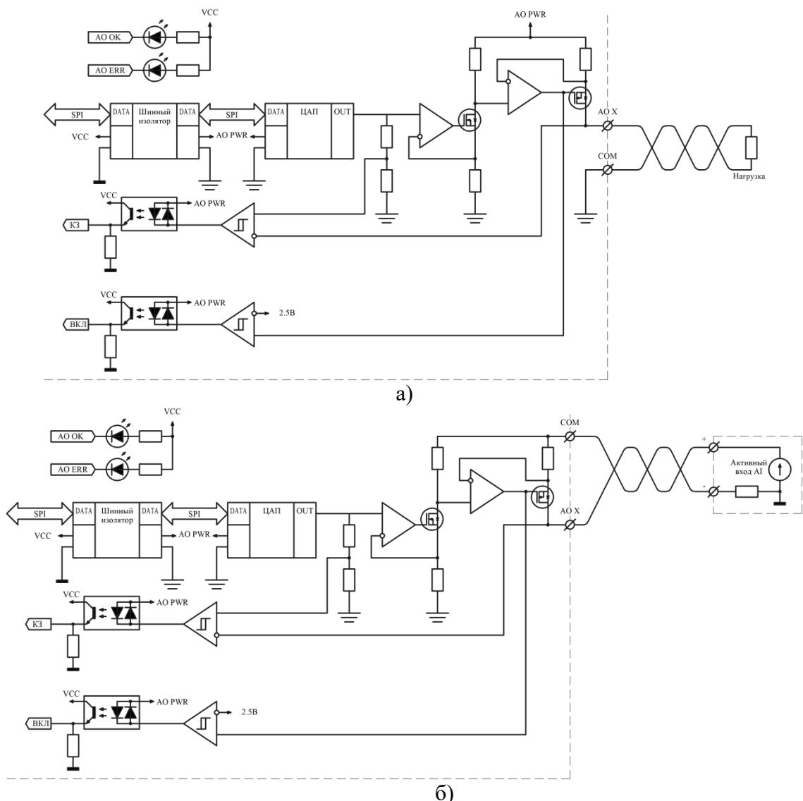
Рисунок 3. Подключение и внутреннее устройство каналов АО с токовым выходом
