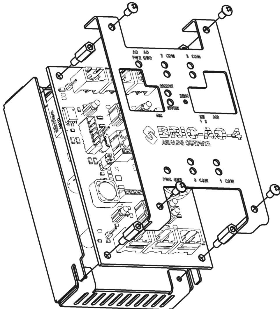
Рисунок 8. Схема разборки модуля
