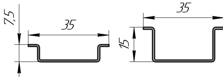
Рисунок 6. Профиль DIN-рейки типа TH-35
